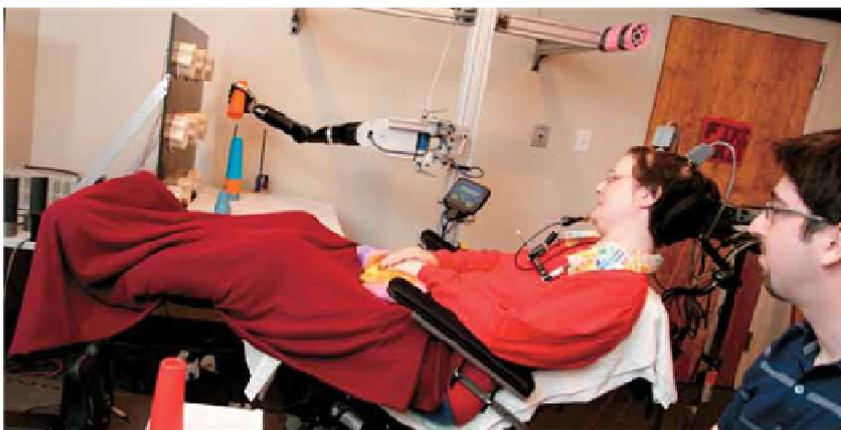
С помощью мысленно управляемой механической руки Дж. Шерман успешно складывает пирамидку из пластмассовых конусов.
